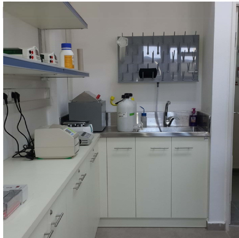
עמדת שטיפה צמודה לקיר + לוח פינים לייבוש משטח וכיור נירסוסטה
